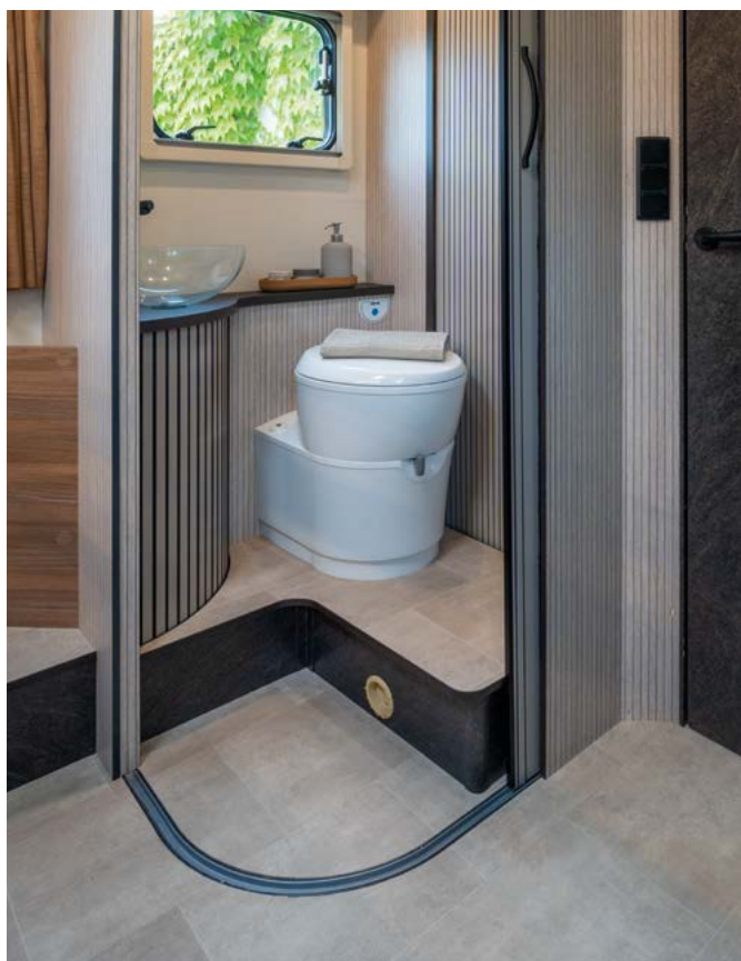
Bac de douche anti-débordement et toilettes séparées avec portes modulables
